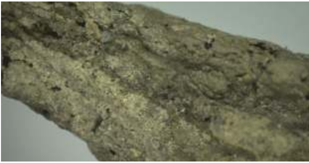
Ryc. 130. Obraz próbki P/64. Widoczne zniszczenie powierzchni materiału oraz obecność licznych kryształów. Pomimo tego w skórze widoczne są małe otworki-pory charakterystyczne dla rozmieszczenia włosów w skórze. Fot. P. Kuroпка Fig. 130. Image of Sample P/64. Visible destruction of the material's surface and the presence of numerous crystals. In spite of this, small opening-pores which are characteristic of hair distribution in skin are visible in leather. Photo P. Kuroпка
