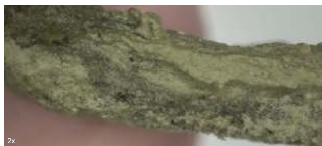
Ryc. 127. Obraz próbki P/57. Widoczne jest pokrycie próbki przez materiał nieorganiczny o bardzo drobnej strukturze. Bliższa analiza wykazała, że najczęściej były to kryształki kwarcu. Fot. P. Kuroпка
