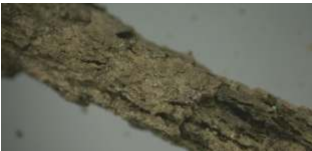
Ryc. 131. Obraz próbki P/212, gdzie widoczny jest efekt ukruszenia się warstwy przykrywającej i odsłonięcie struktur włóknistych leżących poniżej. Fot. P. Kuroпка Fig. 131. Image of Sample P/212, where the effect of crusting of the covering layer and exposure of underlying fibrous structures is evident. Photo P. Kuroпка
