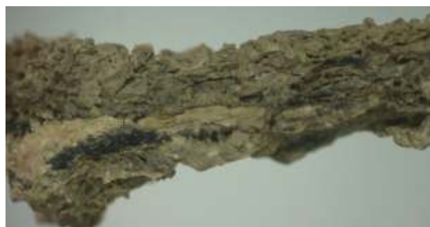
Ryc. 129. Silnie zdeformowana próbka (P/240) wykazująca cechy działania sił ścisających wzdłuż osi długiej fragmentu. Fot. P. Kuroпка
